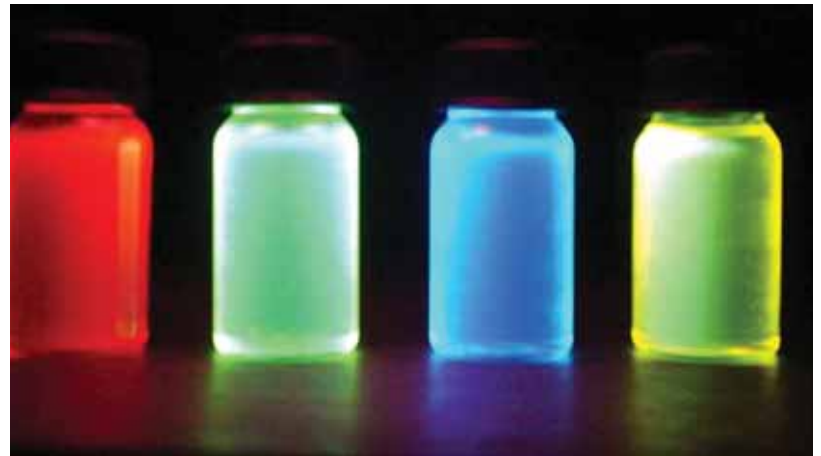
איור 10 | דוגמה לאור צבעוני הנפלט מפולימרים בתגובה להארתם באור לבן, בלא מקור חשמל. לכל פולימר הצבע האופייני לו התמונה לקוחה מאתר חברת Cambridge Display Technology (CDT)
