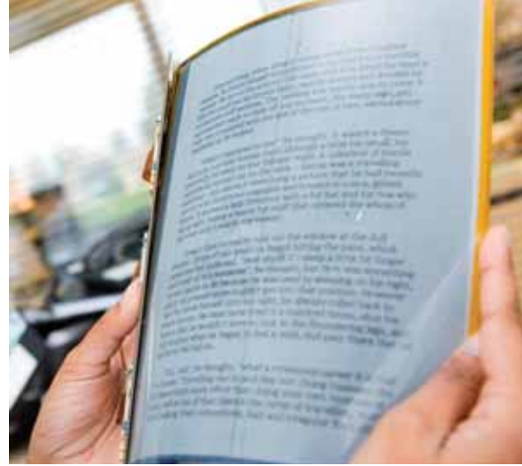
איור 13 | ספר אלקטרוני גמיש הבנוי מטרנזיסטורים אורגניים העשויים מחומר פולימרי התמונה לקוחה מאתר חברת Plastic Logic
