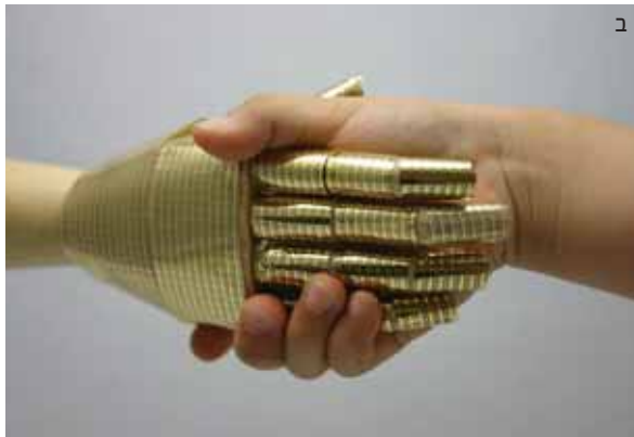
איור 14 (א) יריעה גמישה המכילה טרנזיסטורים של פנטאצן, שמועדה ליצור שכבת "עור" רגישה ללחץ. בשכבת עור זו עוטפים את הרובוט, והדבר מאפשר להעניק לו יכולת מישוש. (ב) היריעה הגמישה מלופפת סביב יד של רובוט ומעניקה לו יכולת לחוש לחץ מאתר אוניברסיטת טוקיו, יפן
