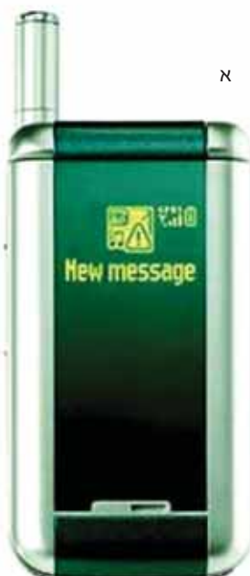
איור 12 | (א) מכשיר טלפון נייד בעל מסכה המתפקד כצג העשוי מ-PLED. (ב) צג טלוויזיה קטן העשוי PLED על גבי שעון
