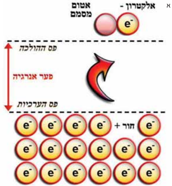
איור 3 | (א) תהליך יצירת החור: האטום המסמם "חוטף" וקושר אליו אלקטרון מפס הערכיות, ובמקומו נשאר חור ה"נע" בפס הערכיות כאילו הוא חלקיק בעל מטען חיובי. (ב) משחק ה-15: המשחק מדמה את פס הערכיות הכמעט מלא לוחיות המספרים אינן יכולות לזוז כל עוד אין לפחות "חור" אחד. ריק, כיוון תנועת החור הפוך לכיוון תנועת הלוחיות
