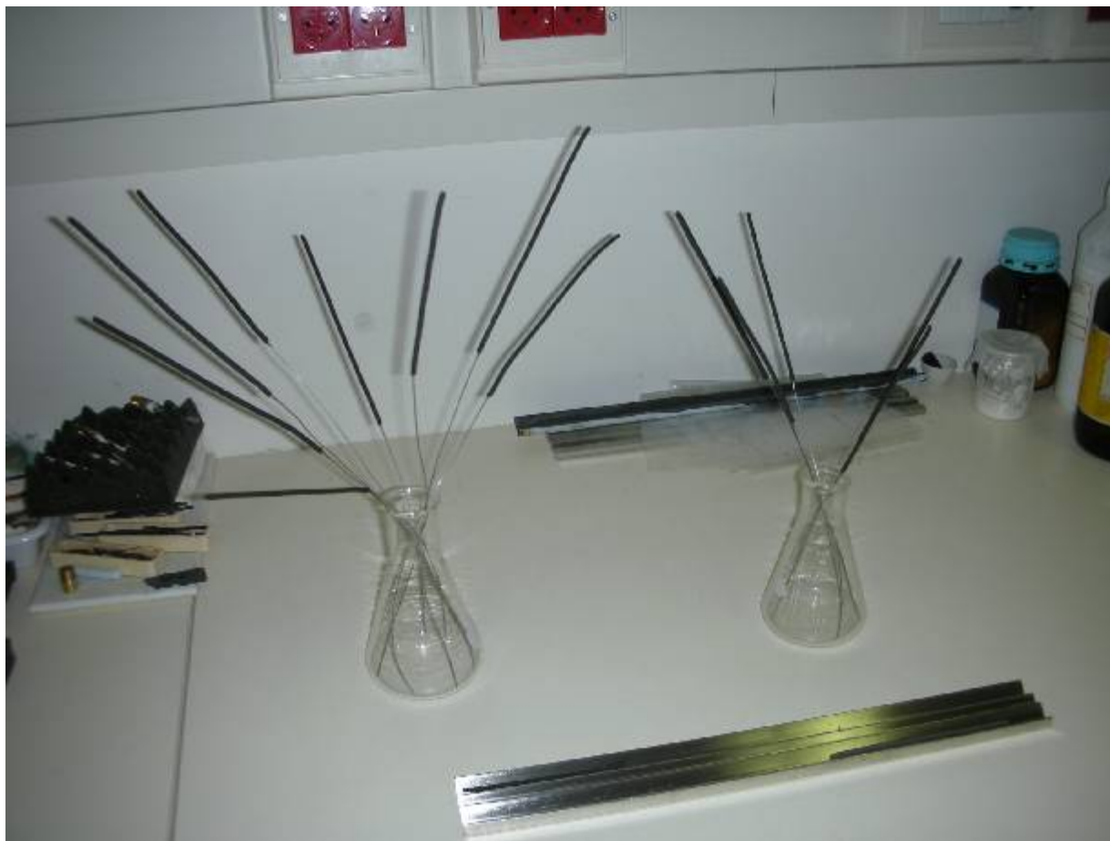
צינורות קרמיים של BSCFO לאחר extrusion בשלב הייבוש לפני סינטור
