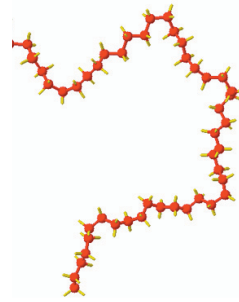
איור 3: תיאור סכימטי של מולקולת פוליאתילן המכילה 50 יחידות-בסיס (מונומרים). פולימרים שכאלה עשויים להכיל מספר גדול בהרבה של מונומרים. כאשר הם מומסים בתמיסה דלילה, הסטטיסטיקה של התצורות האפשריות שלהם שקולה לזו של מהלך אקראי שאינו חותך את עצמו.
